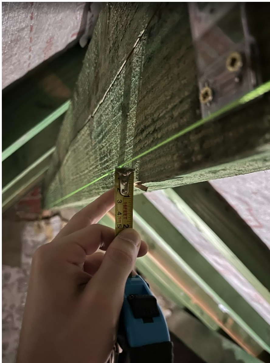
Figure 8 : Mesure de la flèche
